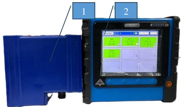
Рисунок 2.3 – Общий вид газааналитического оборудования марки ГАНГ-4РБ 1 – устройства пробоподготовки УП 1/1, 2– разбавитель газовых потоков РС-2, 3– газаанализатор ГАНГ 4РБ, 4 – фильтр сорбционный ФС-1
