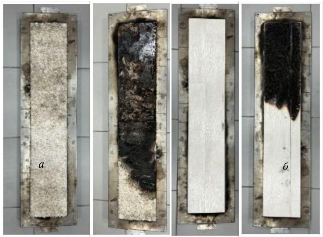
Рисунок 3.37 – Образцы пожарной нагрузки «Ковер из синтетических нитей» (а) и «Линолеум поливинилхлоридный на ингибированной подоснове» (б) до и после испытаний
