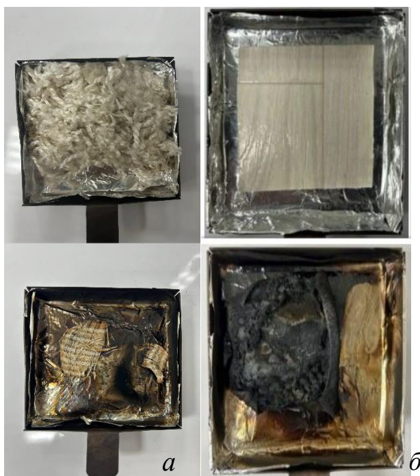
Рисунок 3.8 – Образцы пожарной нагрузки «Ковер из синтетических нитей» (а) и «Линолеум поливинилхлоридный на ингибированной подоснове» (б) до и после испытаний
